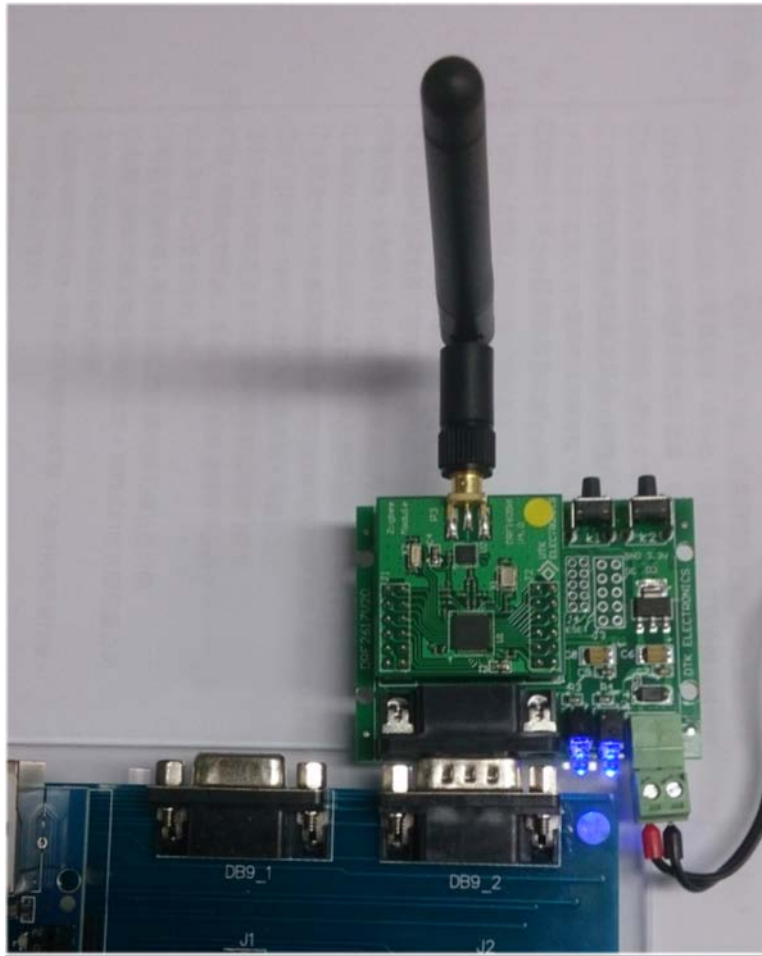
圖 3-9-3 Arduino MEGA2560 與 ZigBee 模組的實體接圖
