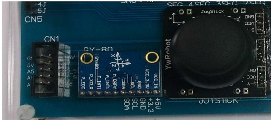
圖 3-10-4 Arduino MEGA2560 對 GY-80 模組的實體接圖
